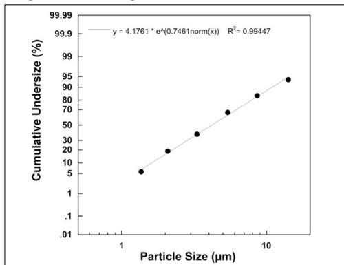
Die Messungen wurden mit einer Natrium-Fluorid-Lösung mit einem „Next Generation Impactor“ (NGI) durchgeführt. Das Diagramm ist möglicherweise so nicht auf Suspensionen oder sehr zähflüssige Medikamente anwendbar.
