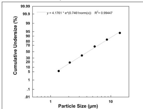
Pomiary zostały przeprowadzone za pomocą roztworu fluorku sodu oraz urządzenia „Next Generation Impactor” (NGI).
