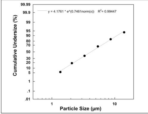
Ölçümler "Next Generation Impactor" (NGI) özellikli bir sodyum florür çözeltisi ile gerçekleştirilir. Diyagram bu nedenle süspansiyonlar veya çok koyu kıvamlı ilaçlar için geçerli olmayabilir. Bununla ilgili ayrıntılı bilgileri ilgili ilaç üreticisinden alabilirsiniz.
