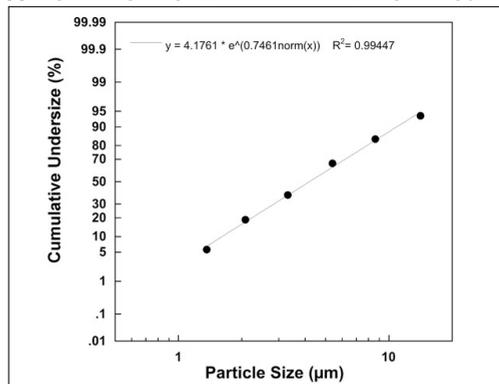
Измерения производились с использованием раствора фторида натрия при помощи импактора нового поколения (Next Generation Impactor = NGI).
